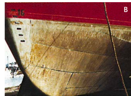
Abbildung 35(a + b): (DKI A 4893 und 4897) Schiffsrumpf aus CuNi10Fe1Mn-plattierten Blechen vor dem Stapellauf (a) und nach 2,5 Monaten Einsatz im Adriatischen Meer (b)
