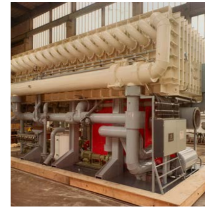
Abbildung 37: Verdampferanlage für die Frischwassererzeugung (500 m 3 /Tag). Kondensatorrohre, Rohre des Enderhitzers, Trennwände, Gehäuse, Destillatwannen; alle Seewasser führenden Leitungen und andere wichtige Teile des Verdampfers bestehen aus CuNi10Fe1Mn
