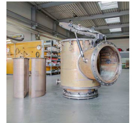
Abbildung 40: Seewassergroßfilter DN700 aus CuNi10Fe1,6Mn für eine Megayacht
