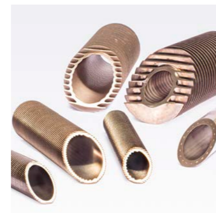
Abbildung 36: Rippenrohre aus CuNi10Fe1Mn für Wärmeübertrager, die mit Seewasser, Poolwasser oder Brunnenwasser betrieben werden
